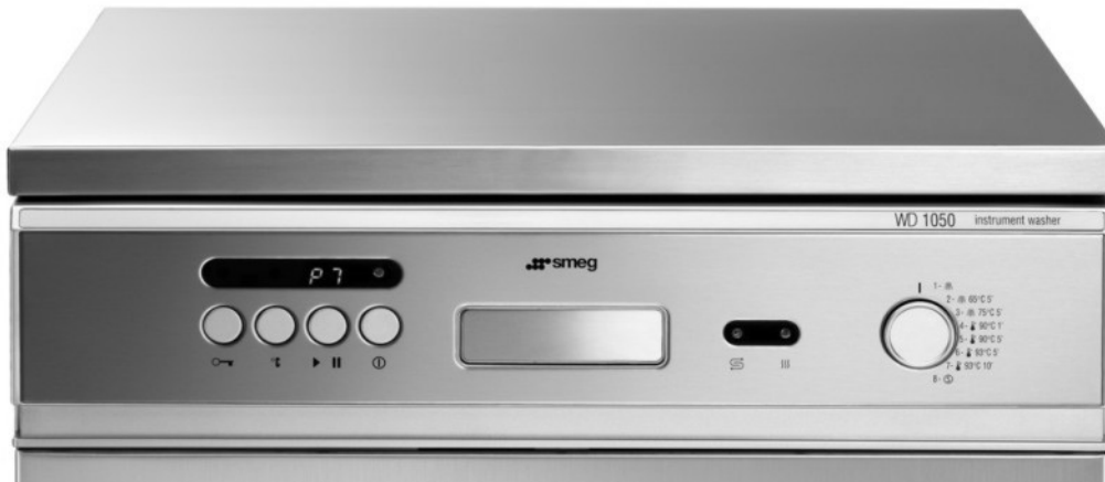
Abb. 1 – Bedienblende WD2050. Zum Entriegeln der Tür ist es erforderlich: 1 - Das Gerät einzuschalten (Symbol ON/OFF), 2 – Die Taste mit dem SCHLÜSSEL-Symbol (erste Taste links) zu betätigen und einige Sekunden abzuwarten.
