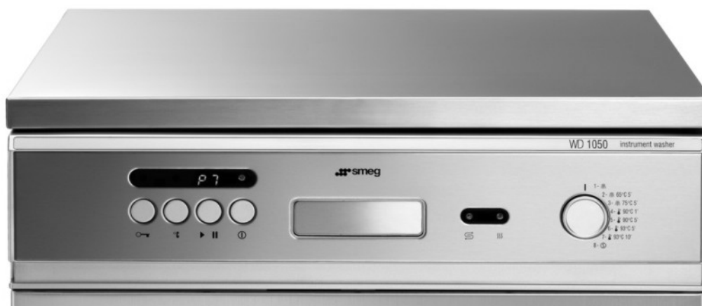
Abb. 1 – Bedienblende WD1050. Zum Entriegeln der Tür ist es erforderlich: 1 - Das Gerät einzuschalten (Symbol ON/OFF), 2 – Die Taste mit dem SCHLÜSSEL-Symbol (erste Taste links) zu betätigen und einige Sekunden abzuwarten.
