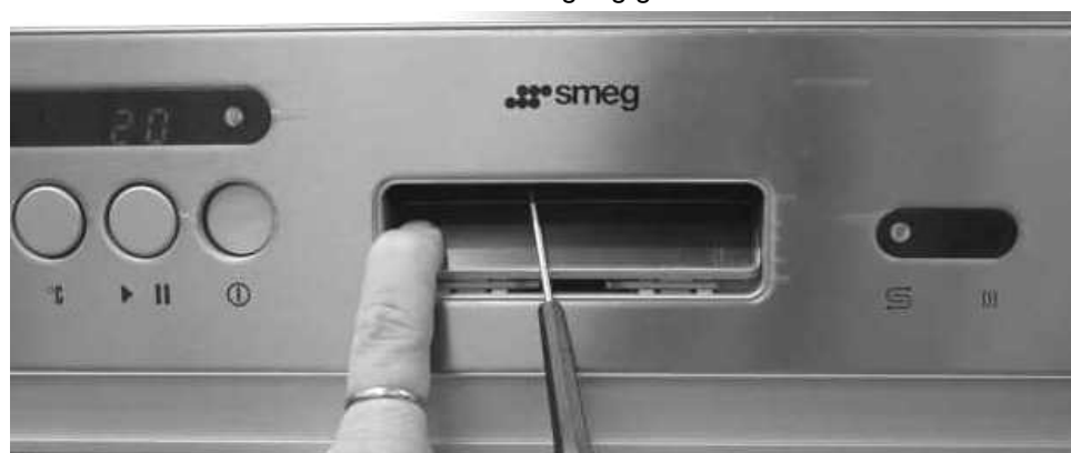
Abb. 2 – Bedienblende WD1050. Zum manuellen Entriegeln der Tür ist es erforderlich: 1 – Auf den Griff zum Öffnen zu drücken, um Zugang zum Öffnungsmechanismus zu erhalten, 2 – Durch Drücken nach unten Kraft auf den Öffnungsmechanismus auszuüben.
