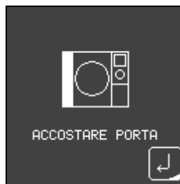
Abb. 44 – Bildschirmseite für das Annähern der Tür, mit der Taste „Zurück“ kehrt der Bediener auf die vorhergehende Seite zurück.
