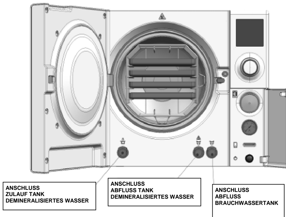
Abb. 18 – Vordere Anschlüsse für den Zulauf/Ablauf des Wassers
