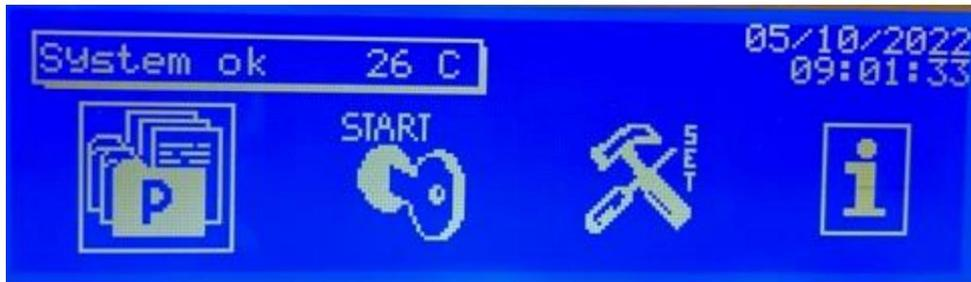
Oben links wird die Innenmuffeltemperatur angezeigt.
