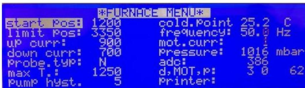
Durch Auswahl von „Ofen-Setup“ aus der Anzeige in Abb. 20 und Drücken von ENTER haben Sie Zugriff auf das folgende Untermenü „OFENMENÜ“:
